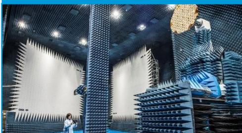
Isto é Hertz Hybrid European RF e Antenna Test Zone da ESA para testes de antenas em ESTEC, conhecido antigamente como o Compact Payload Test Range. As paredes de metal protegem dos sinais de rádio exteriores enquanto o revestimento interior de espuma pontiaguda absorve os sinais internos de modo a criar as condições que simulam o vazio infinito do espaço
