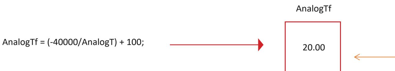
**Lignes 12 à 15** : Pour afficher la mesure de la température à l'écran, vous devez utiliser la fonction d'impression. Cette fonction permet de récupérer le numéro à l'intérieur de n'importe quelle boîte et de l'imprimer dans le Serial monitor. Dans cet exemple, la fonction imprimera le numéro à l'intérieur de la boîte appelée **AnalogTf**. Tous les mots contenus dans le "..." sont directement imprimés sur le moniteur de série.
